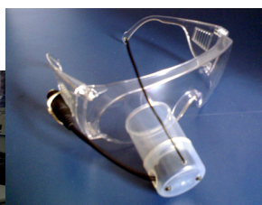
Dispositivo em forma de óculos para rastrear o movimento da retina
